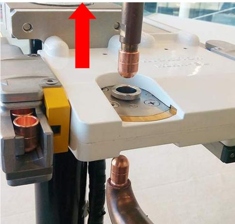
7. 后退后，将焊枪对正装置取出。
