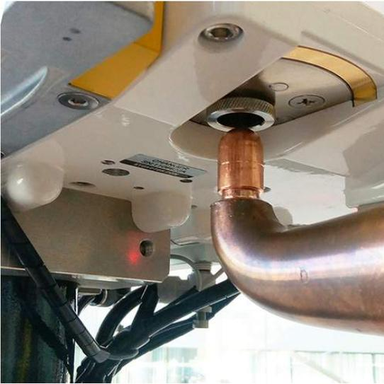
5. 插入到中心位置后,与上侧一样,将焊枪对正装置取出,再次将电极再次插入拆帽头,直到电极的上表面和拆帽头平齐为止。
